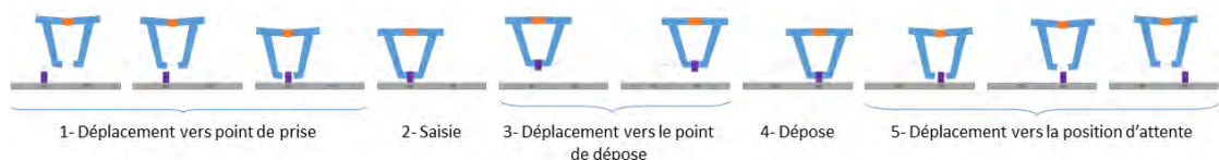
FIGURE 4.15 – Définition du cycle avec position d’attente. Dans le cadre de ce cycle, le robot attend l’objet à une position d’attente avant d’aller le chercher au point de prise pour l’emmener au point de dépose et retourner à la position d’attente avant d’aller chercher l’objet suivant.
