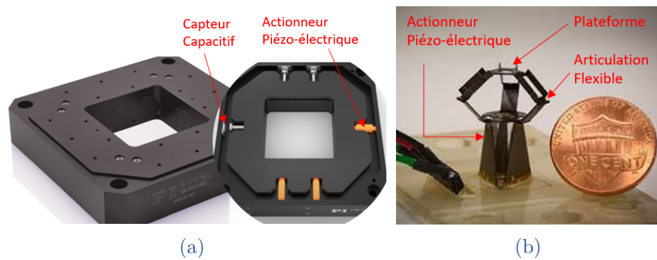
FIGURE I.7 – Exemple de robots à articulations flexibles. (a) Plateforme parallèle 6 DdL de l'entreprise Physik Instrumente (b) MilliDelta de l'université d'Harvard [McClintock 18]
